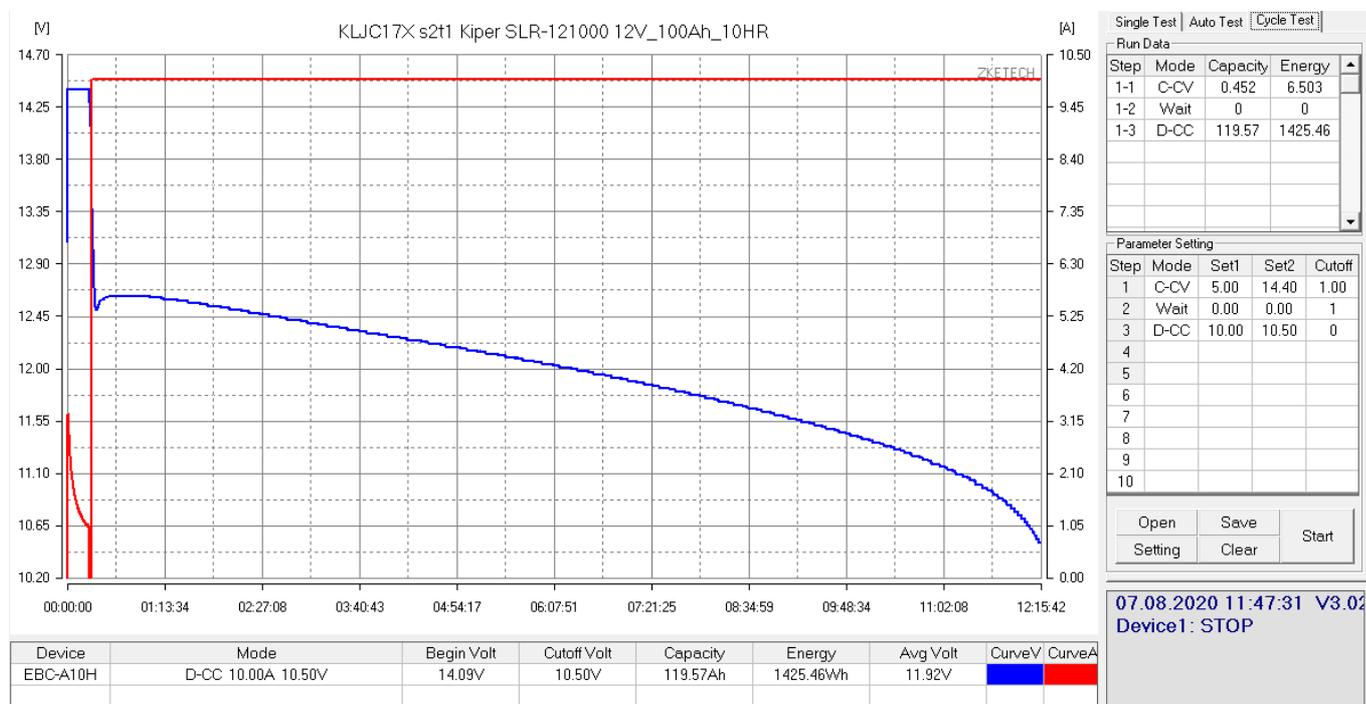
**Вывод: данная аккумуляторная батарея соответствует заявленной емкости, реальная емкость выше номинальной.**
